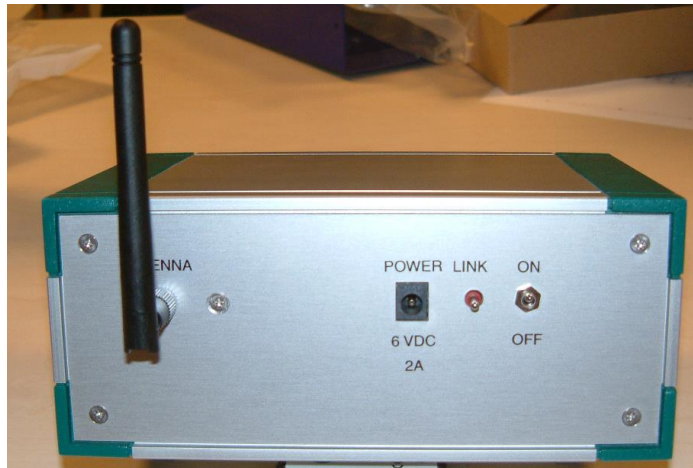
Figuur 2 Achterzijde van de I-VAC – I-On. Van links naar rechts: antenne, aansluiting voor netwerk adapter, schakelaar voor afstemmen op antenne en aan-uit schakelaar.
